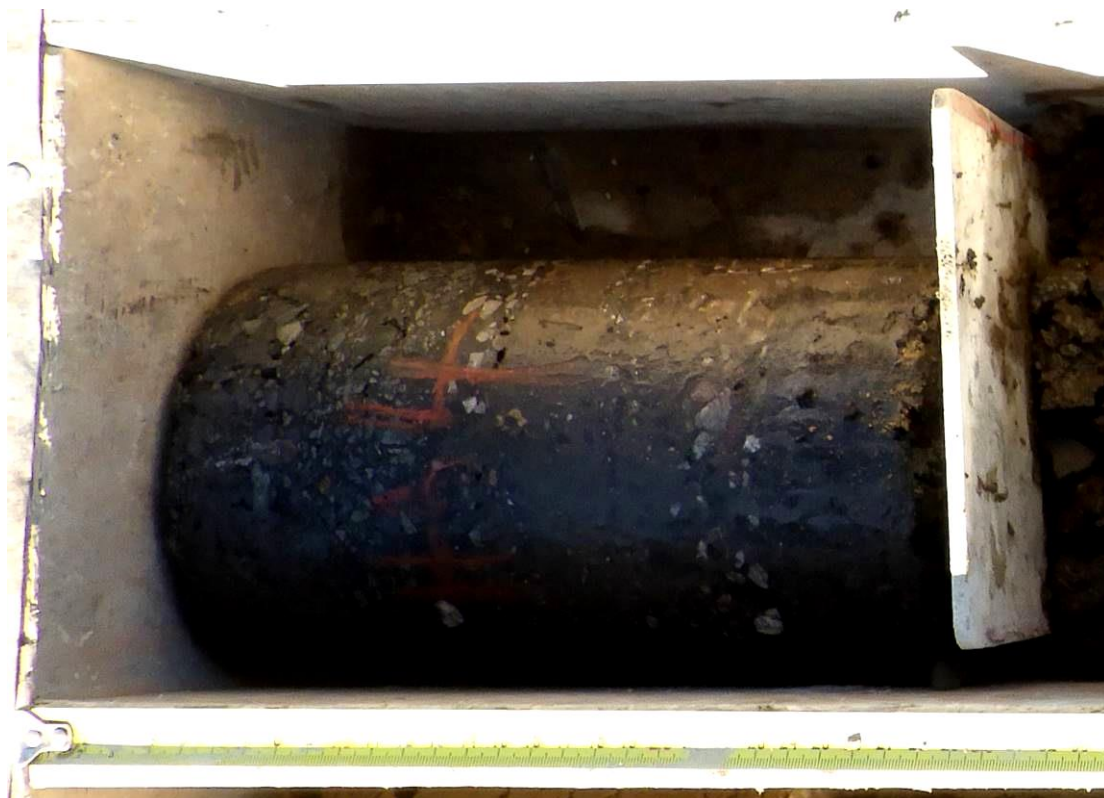
Detail asfaltových vrstev HS 4-1
