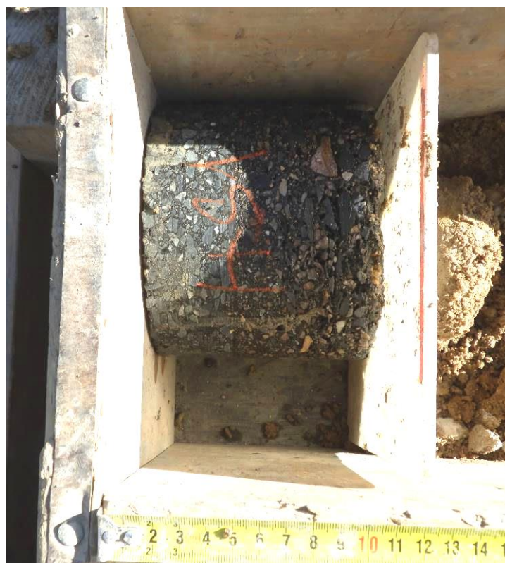
Detail asfaltových vrstev HS 1-1
