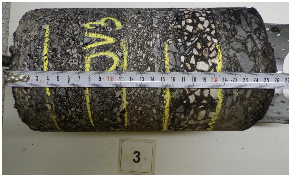
Vývrt JV 3 hloubkové sondy HS 4
