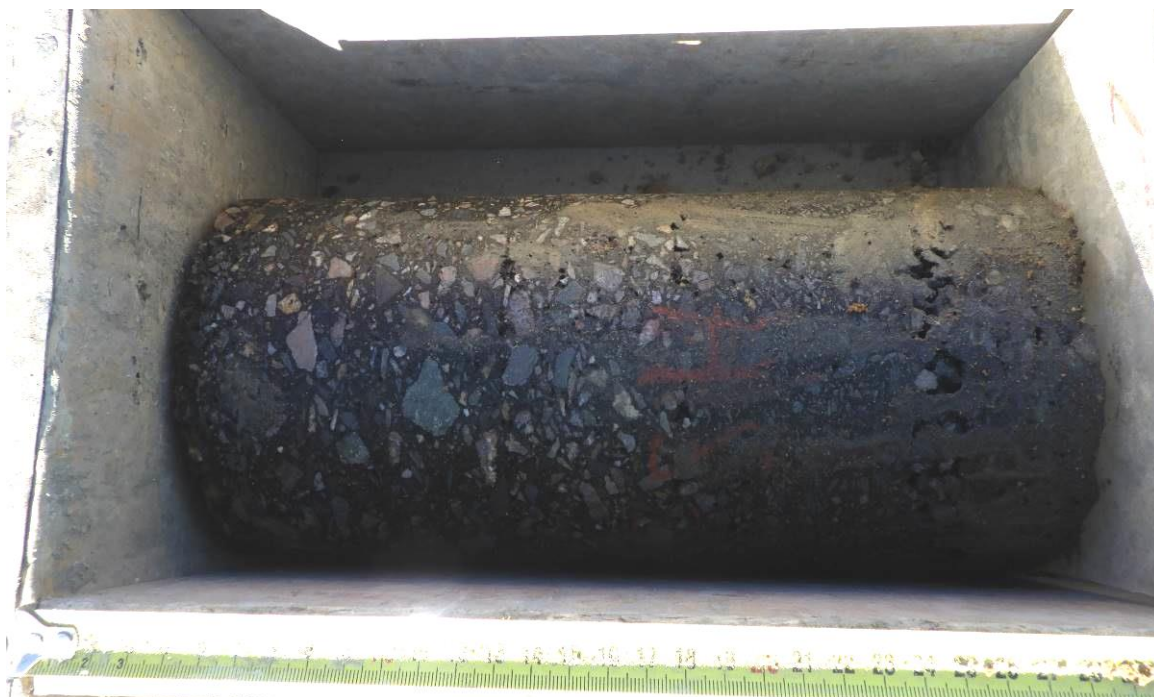
Detail asfaltových vrstev HS 3-1
